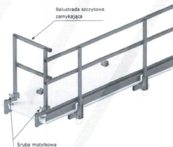
Balustrada szczytowa zamykająca na pomoście wiszącym
